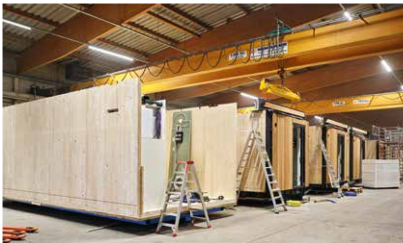
Productie van Finch Buildings-componenten. Hout biedt nieuwe mogelijkheden voor prefabricage en industrialisatie. De voordelen daarvan zijn legio: minder bouwafval, hogere bouwsnelheid, minder gespecialiseerd personeel op de bouwplaats, minder transporten, minder stikstofuitstoot.
